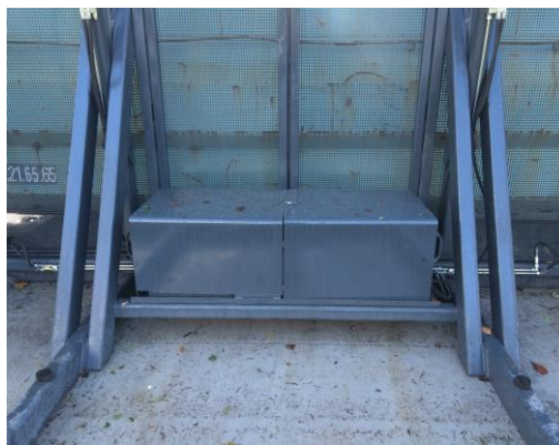
• Centrale hydraulique cartésisée
