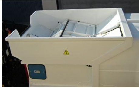
Volets de fermeture hydrauliques pour éviter l'envol des déchets dans les phases de roulage
