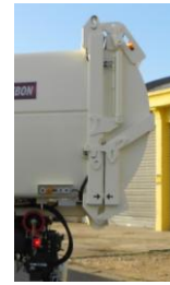
Benne conique à bords arrondis, porte étanche
