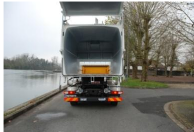
Benne conique à bords arrondis, porte étanche
