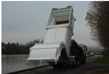
Porte arrière hydraulique, articulée par le haut pour un vidage sécurisé en fosse
