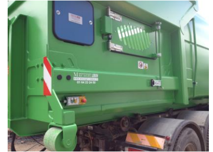
Trappe de débourage translucide, sécurisée
