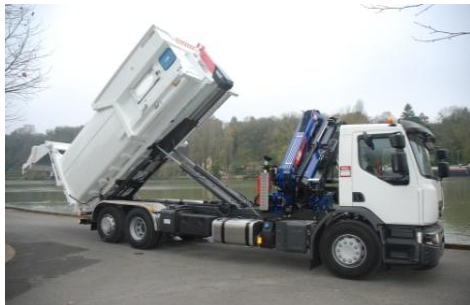
Porte arrière hydraulique, articulée par le haut pour un vidage sécurisé en fosse
