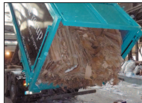
• Toit ouvrant en phase de vidage (Opening roof section in emptying phase)
