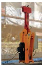
L'une des dernières innovations du fabricant français Huchez est un système "d'optimisation dynamique de puissance". Un variateur adapte automatiquement, et à chaque instant, la vitesse du treuil à l'effort requis, offrant ainsi un gain de temps très net lors de l'enroulement ou du déroulement à vide ou quand l'effort est moindre. Option proposée sur les treuils destinés au halage et sur les cabestans (traction de wagons, accrochage d'amarres... ).
