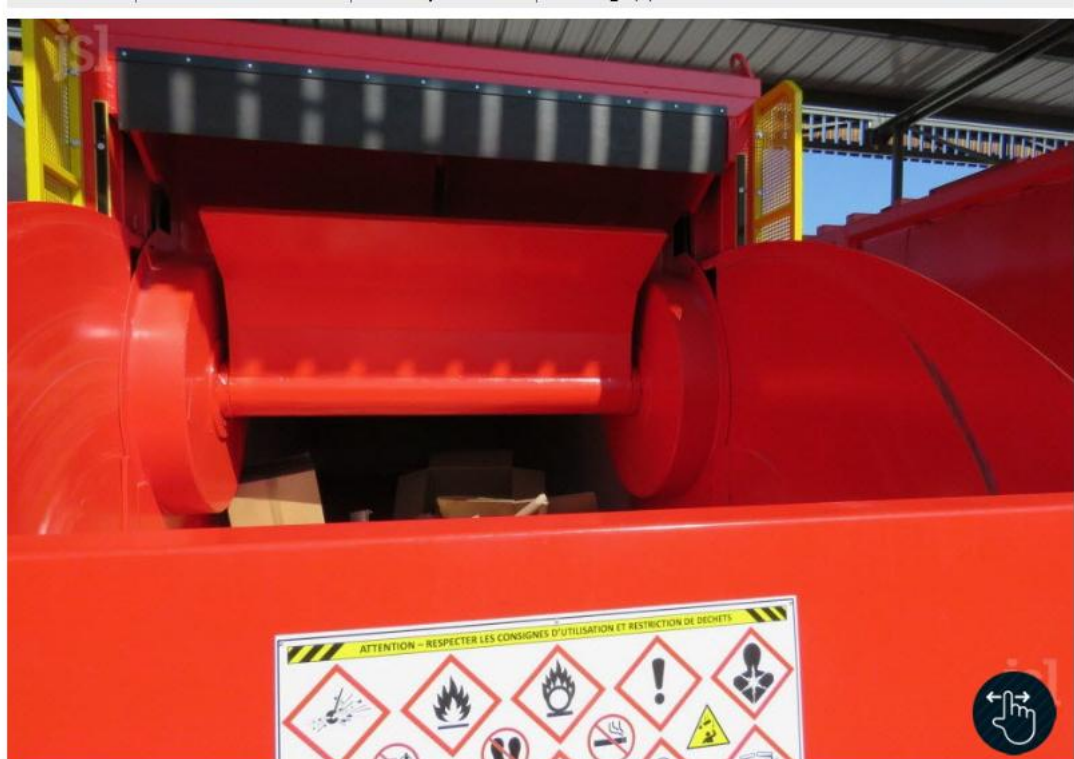
■ La visite continue par la démonstration d'un compacteur ouvert et en action pour les déchets non recyclables. Ici, on aperçoit des cartons dans la machine. Photo Joseph Sala (CLP)
