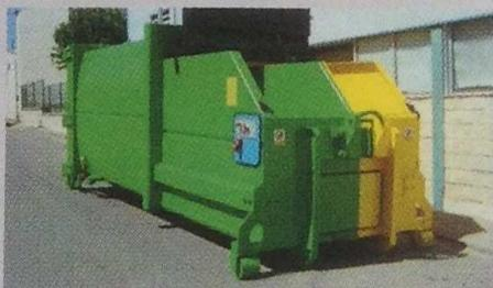
Le KA 4 développé par Gillard est un compacteur monobloc bi-compartmenté adapté à la collecte sélective. Sa capacité est de 18 m<sup>3</sup>, répartie en un compartiment dédié aux papiers/cartons (10,5 m<sup>3</sup>) et un deuxième aux déchets ménagers (7,5 m<sup>3</sup>). Un lève-container est intégré pour soulever les bacs 2 roues. La durée du cycle de compaction est de 38 secondes.
